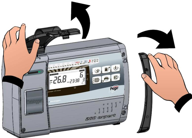
**Fig. 1:** Sollevare lo sportello trasparente di protezione slot SD e rimuovere la copertura delle viti sul lato destro.
